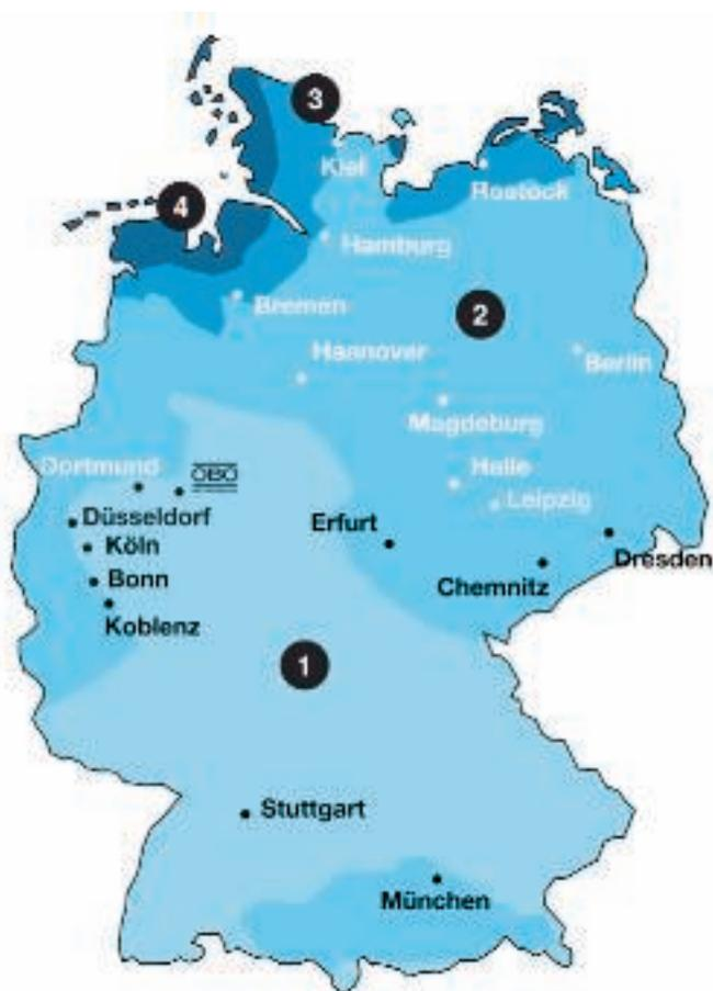
Зоны ветровой нагрузки в Германии в соответствии с DIN 1055-4
