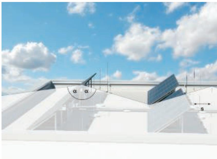
$\alpha^\circ$  = защитный угол,  $s$  = разделительный интервал
