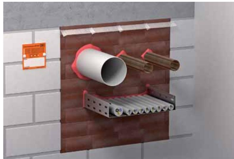
Комбинированная проходка ОВО FBA-B200 состоит из огнестойких пеноблоков. В случае возникновения пожара пеноблоки расширяются без возникновения существенного давления, образуя при этом изолирующую углеродную пену, препятствующую проникновению огня и дыма через проходку.
