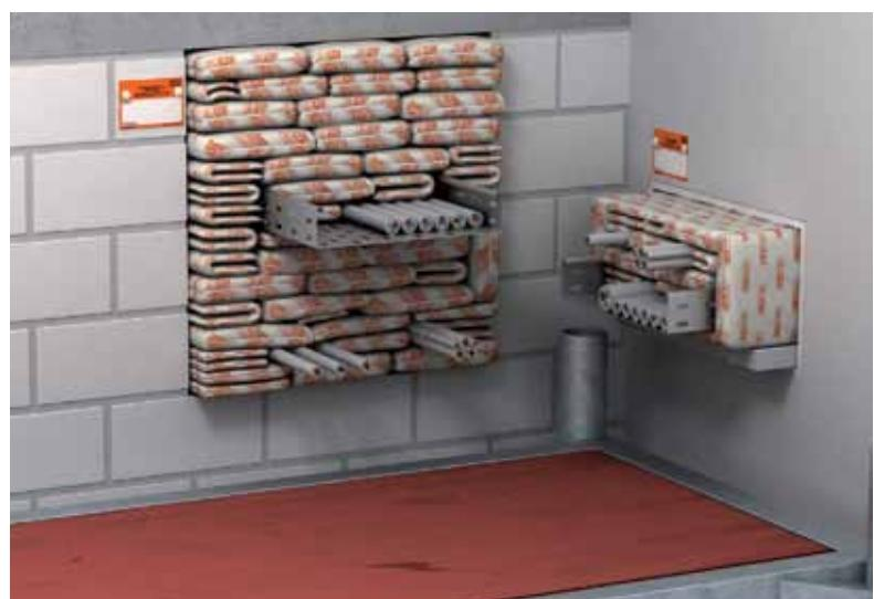
Огнестойкие подушки ОВО KVK являются простым и удобным средством для создания проходки при прокладке кабеленесущих систем через стены или перекрытия. Эластичным огнестойким подушкам KVK можно придать любую форму. Прокладка дополнительного кабеля возможна в любое время, т. к. подушки пригодны для повторного использования. Подушки KVK состоят из плотной прочной стеклоткани со специальным наполнителем, устойчивым к воздействию влаги, без содержания асбеста и минеральных волокон.
