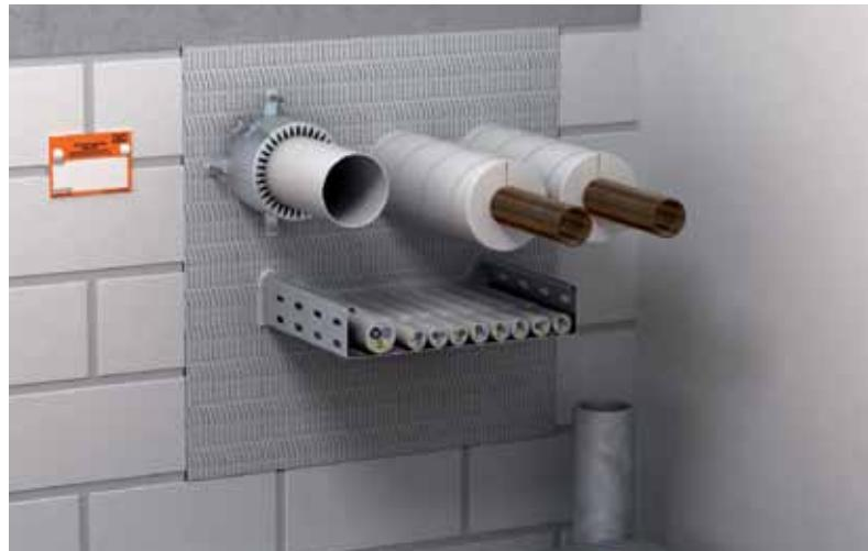
Огнестойкие панели OBO FPS являются эффективным средством создания кабельных проходок. Основа системы - панель из минерального волокна с нанесенным на нее огнестойким покрытием. После монтажа панелей не требуется нанесения дополнительного покрытия. В случае возникновения пожара огнестойкое покрытие панели вселяется, образуя изолирующую углеродную пену, которая препятствует распространению огня и дыма. Такая же реакция при пожаре возникает у покрытия, которое необходимо наносить на кабель.
