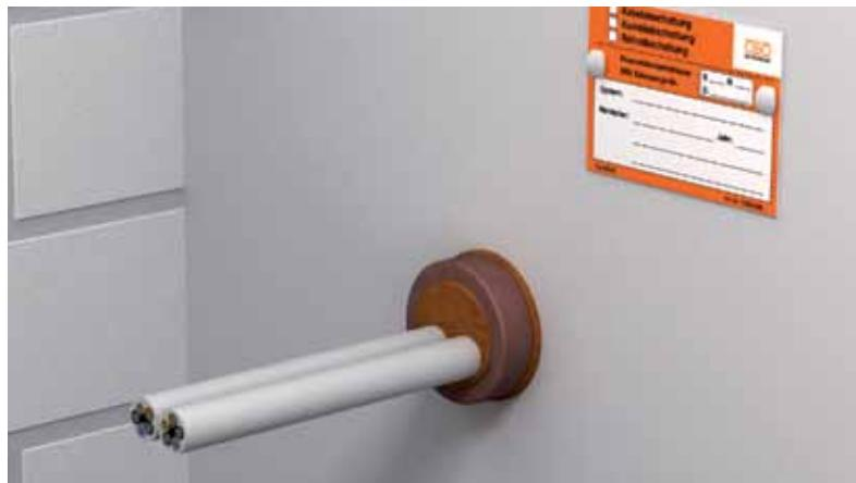
Огнестойкая шпатлевка OBO FBA-SP является оптимальным решением при установке небольших круглых кабельных проходок. В случае возникновения пожара огнестойкая шпатлевка расширяется и полностью закрывает отверстие.
