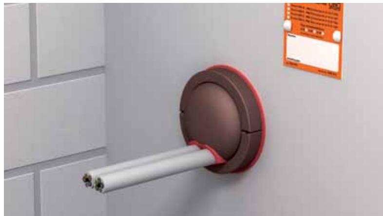
Надежным средством создания круглых кабельных проходок в легких разделительных перегородках являются огнестойкие оболочки FBA-SR. Помимо легких разделительных перегородок допускается их монтаж в монолитных стенах. Такая круглая проходка состоит из разделенной на две части твердой оболочки с наружным диаметром 140 мм и двух заглушек FBA-S. Обе заглушки изготовлены из прочноэластичного материала, оболочка – из твердого состава. Полезная площадь оболочки составляет 60% ее общей площади.
