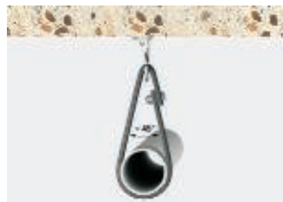
Вариант нагрузки 6: лента обвязана вокруг плоской проушины и трубы или вокруг подобного Допустимая нагрузка 2xВ
