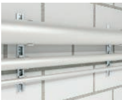
Применение рейки с зажимом Quick из алюминия Зажим Quick используется также в комбинации с рейками. Это значит, что зажим может быть установлен в профильных рейках с шириной прорези 11 мм. Это может быть использовано, в случае, если системы труб необходимо монтировать на крепежной опоре «профильная рейка».
