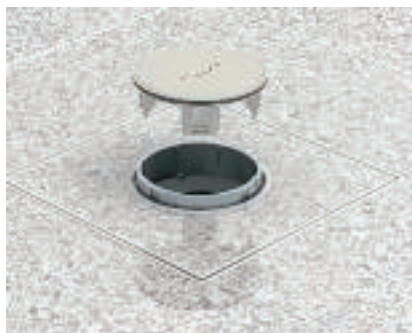
Монтаж тубуса Вставить крышку тубуса в рамку и опустить. Зафиксировать тубус, повернув его направо.
