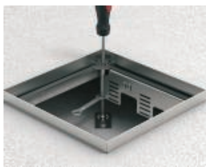
Регулирование высоты кассетной рамки Установить кассетную рамку на верхнюю кромку напольного покрытия. Отрегулированную высоту нивелировочных винтов зафиксировать с помощью контргаяк.
