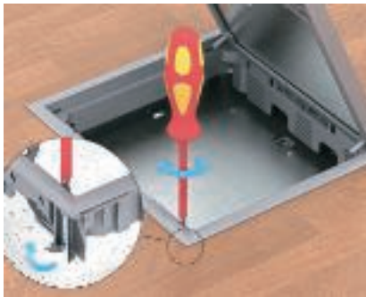
Универсальное крепление лючков GES.-2 при монтаже в кабельных каналах Крепежный уголок при привинчивании автоматически поворачивается наружу. Он заходит под монтажную крышку.
