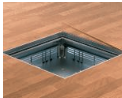
Укладка напольного покрытия вокруг кассетной рамки RKS Оставшийся зазор между напольным покрытием и кассетной рамкой уплотнить с помощью соответствующего материала (например, с помощью пробковой полоски).
