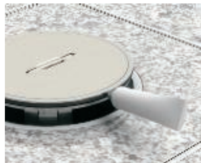
Очистка уплотнителей По завершении монтажных работ очистить внутреннее пространство кассетной рамки, уплотнители и тубус. Смазать уплотнители вазелином (входит в комплект поставки).
