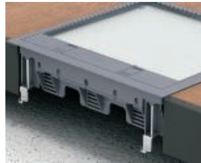
Универсальное крепление лючков GES.-2U при монтаже в двойном полу, s \geq 47 мм Отсоединить крепежный уголок от винта и повернуть. Снова установить винт в крепежный уголок. В этом положении диапазон зажима составляет 37 - 75 мм.
