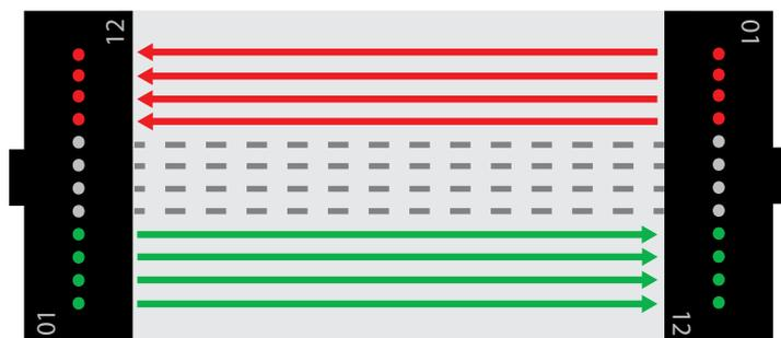
**Рис. 2. Принцип полнодуплексной передачи с использованием 8 волоконных световодов в 12-волоконном соединителе MPO для 40GBASE-SR4 и 100GBASE-SR4**
