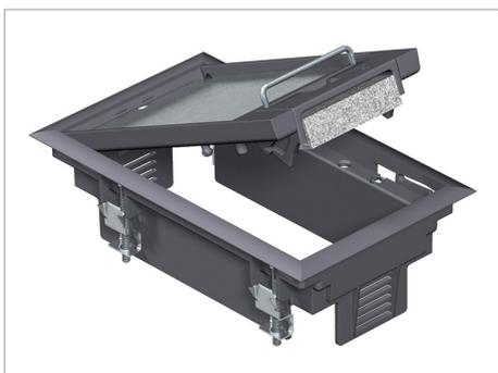
Лючок для 3 электроустановочных изделий серии Modul 45 в 1 монтажной коробке GB2 для установки в системах кабельных каналов. С универсальным крепежным уголком. Защитная рамка для кромки напольного покрытия, откидная крышка и кабельный вывод из полиамида. Углубление в откидной крышке 5 мм для напольного покрытия.
